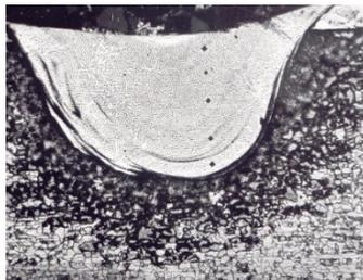
**Рис. 2.** Микроструктура стали 20 после лазерного легирования хромом, x100
