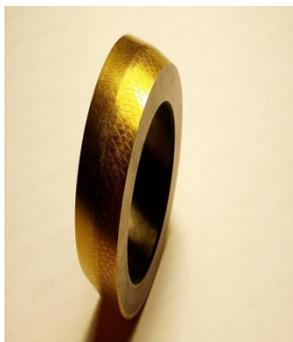
**Рис.1 Деформирующий элемент для дорнования отверстий по патенту РФ №2560477 с PMP поверхности и износостойким покрытием.**
